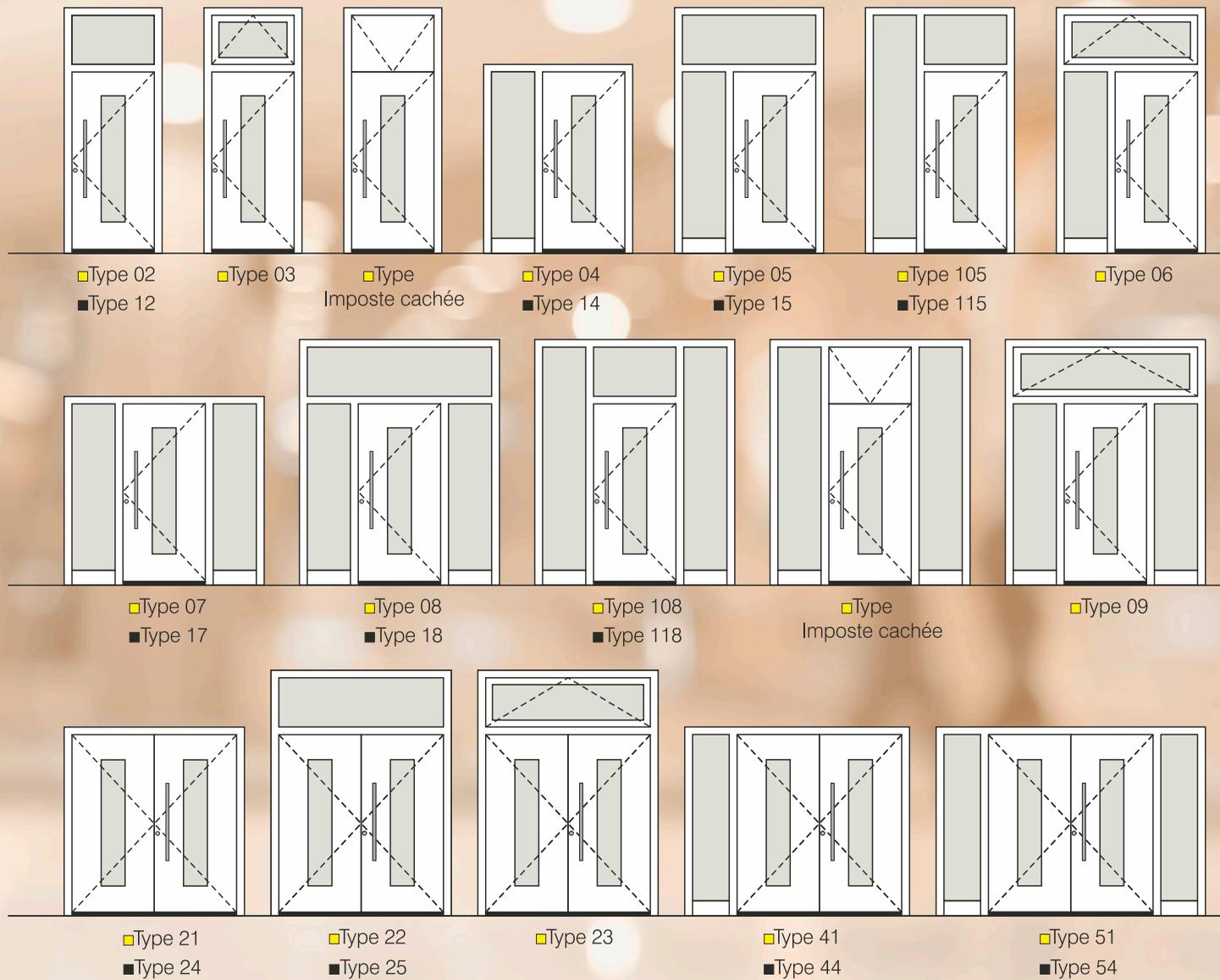
La réalisation de l'ensemble des modèles du programme Exclusive sont livrables dans les réalisations différentes avec des parties latérales et des impostes quelque soit le sens d'ouverture (gauche ou droite).
