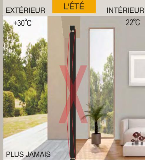
Les conditions climatiques, en hiver comme en été, peuvent provoquer un choc thermique déformant l'ouvrant et compliquant l'utilisation de la porte. Pour y remédier, nous avons conçu un battant breveté avec joint de dilatation, améliorant la rupture de pont thermique. Ce joint, placé entre le panneau extérieur et les profilés, renforce l'étanchéité et la rigidité entre le dormant et l'ouvrant des portes Exclusives.
